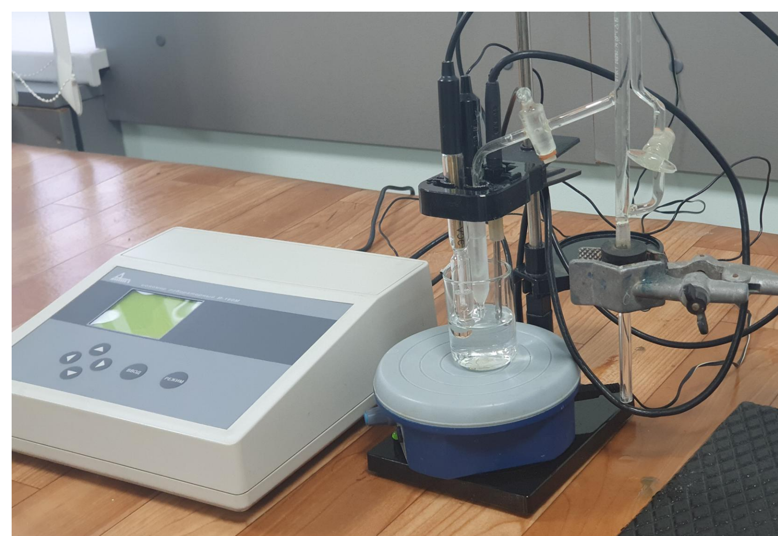
Fig.1. Instalația utilizată la titrarea soluției de clorhidrat de drotaverină cu soluție de NaOH 0,1 mol/l.
